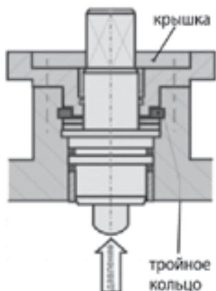
6) Для шпинделя шарового крана BROEN BALLOMAX®, монтируемого внутри корпуса, используется тройное кольцо, защищающее шпиндель от вырывания из корпуса рабочей средой, находящейся под давлением. Герметичность по диаметру шпинделя и в отверстии корпуса создаётся тарельчатыми пружинами, которые оказывают постоянную осевую нагрузку на уплотнительный набор из фторопласта (PTFE) (см. рис. 2).
